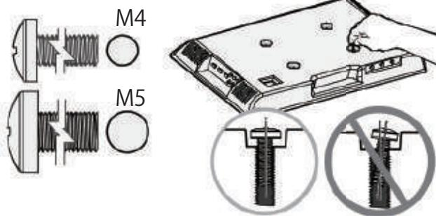
お使いのテレビのネジ穴の形状によって、使用する部品が決まります。テレビの背面のネジ穴に手でネジを入れて、適合する正しいネジの直径を確認してください。
