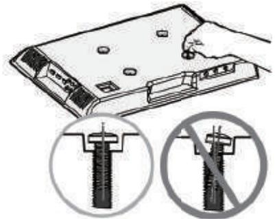
お使いのテレビのネジ穴の形状によって、使用する部品が決まります。テレビの背面のネジ穴に手でネジを入れて、適合する正しいネジの直径を確認してください。ご使用のテレビに対して、ネジやスペーサーを組み合わせて、適正なネジ山のかみ合わせを確認してください。
