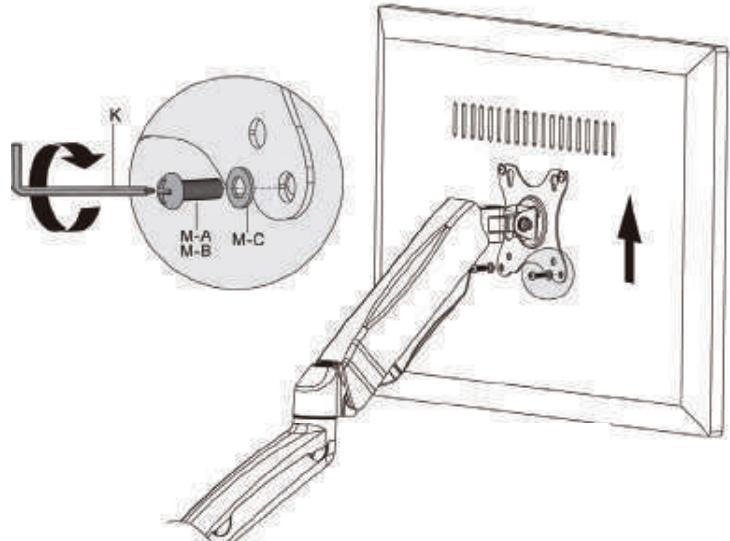
お使いのテレビのネジ穴の形状によって、使用する部品が決まります。テレビの背面のネジ穴に手でネジを入れて、適合する正しいネジの直径を確認して下さい。
