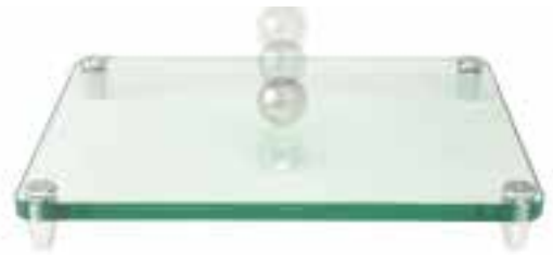
1kgの鉄球落下テストの画像
