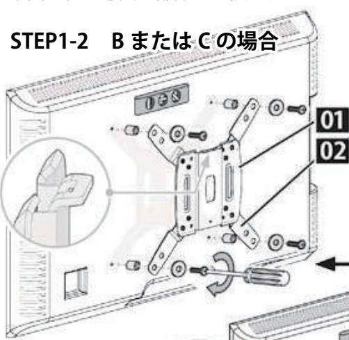
VESA200、VESA200×100 でご利用になる場合、拡張アダプターの M4x8mm ネジ [03] を緩めておき、テレビ背面に取り付けてから拡張アダプターの M4x8mm ネジ [03] を締め付けて固定してください。
