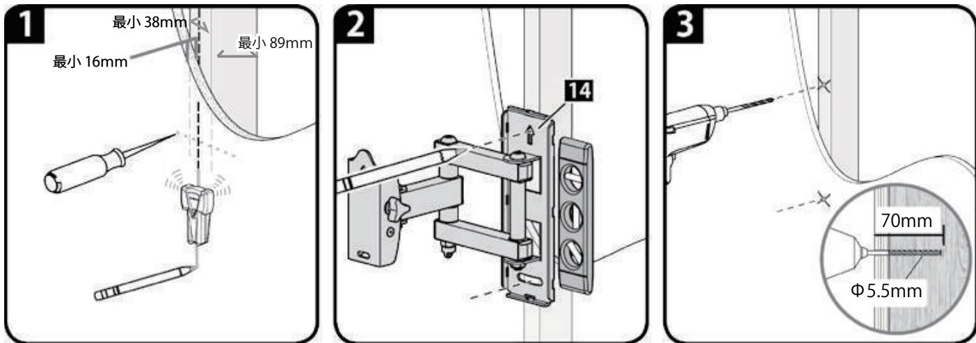
**注記:** 下地センサー（木柱センサー）は壁の中にある下地材をセンサーで感知して知らせてくれるものです。
