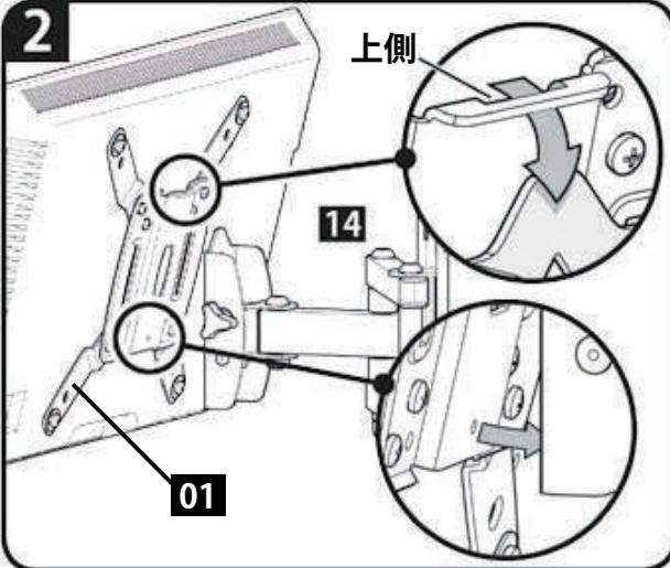
1. 壁掛け金具 [14] のアームの先端部の爪を図のようにテレビに取り付けたTVブラケット [01] の取付部に差込み引っ掛けます。
