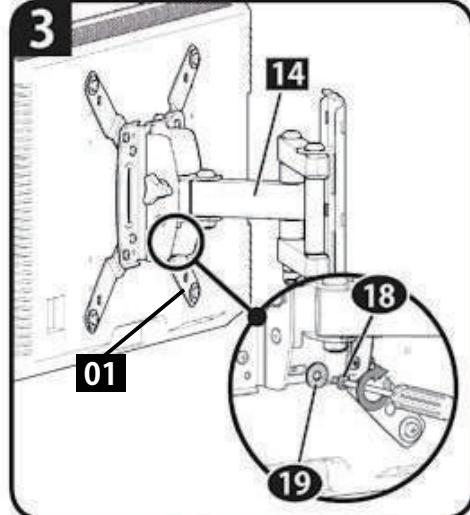
2. 壁掛け金具 [14] のアーム先端部下のネジ取付窓に、ロックネジ用ワッシャー [19] をロックネジ [18] に差込んでから、テレビブラケット [01] のネジ穴にねじ込んでテレビブラケット [01] を固定します。
