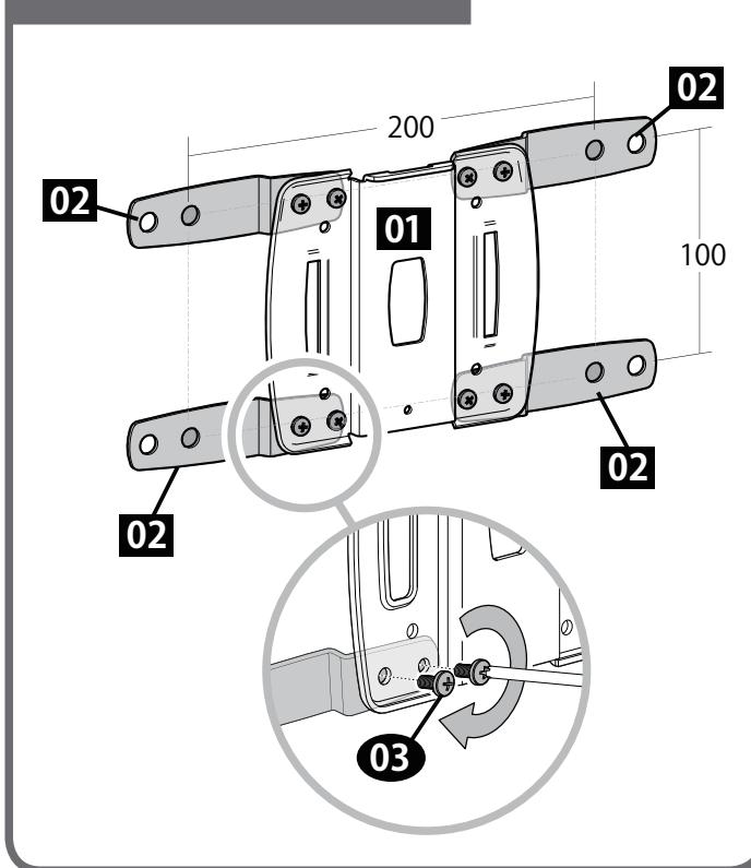
B及びCの場合は、テレビブラケット用アーム[02]をM4x8mmネジ[03]を使い上図のように固定して使用してください。
