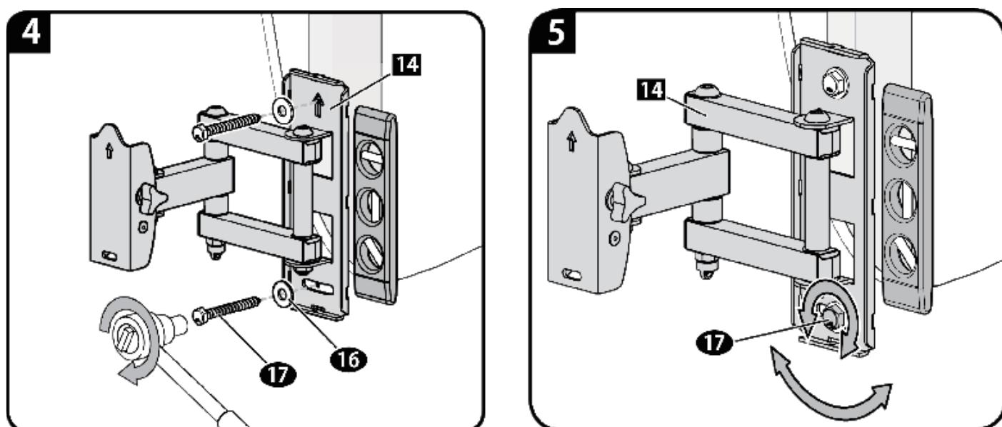
4. 壁掛金具 [14] を下穴に合わせて柱に配置し、ラグボルト [17] とラグボルトルッシャー [16] で固定します。この時、下側のラグボルト [17] は仮止め程度にゆるく締めておきます。
