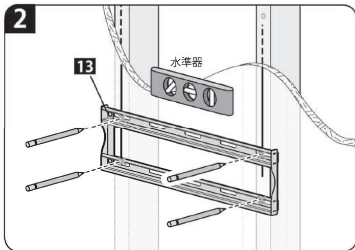
3. 下穴は、柱に3mm径のドリルを使って、深さ約70mmの穴を4箇所開けます。
