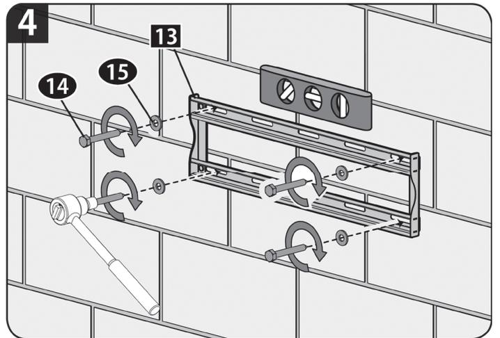
4. 4本のラグボルト [14] とワッシャー [15] を壁掛金具 [13] にしっかりと締めつけて、壁掛金具 [13] を固定します。
