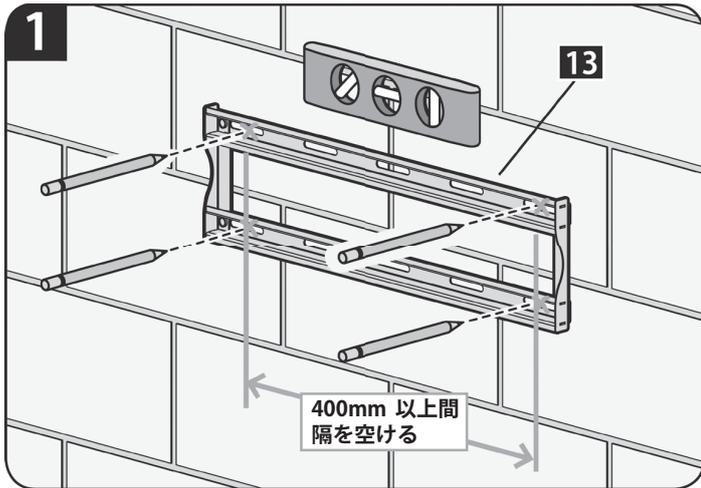
1. 壁面の希望の高さに、壁掛金具 [13] を配置します。型紙は水準器で水平を確認してから、穴位置に4箇所のマーキングを付けます。
