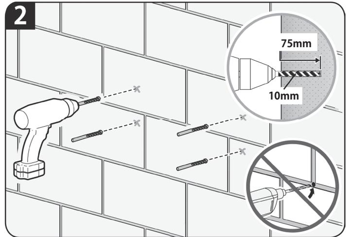
2. 下穴は、10mm径のドリルビットを使って、必ず75mmの深さに穴を4個開けます。
