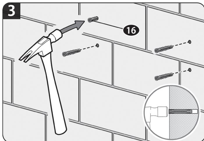
3. 2. で開けた4個の下穴にコンクリートアンカー [16] を打ち込みます。
