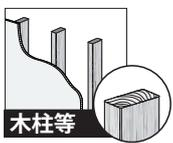
★ 金具を取付ける柱の寸法は、取付ける面の幅 38mm 奥行き 89mm以上が必要です。
