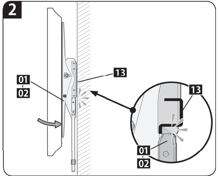
1. STEP 1でテレビに取付けたTV ブラケット [01] または [02] の上部のスリットを壁掛金具 [13] の上部に引っ掛けて取り付けます。
