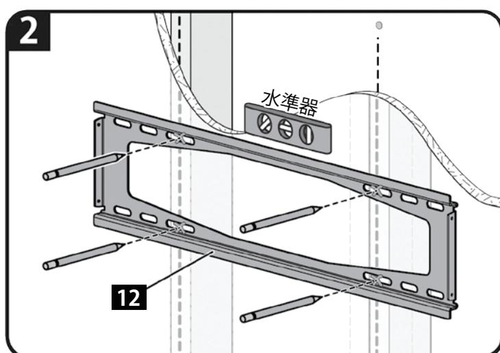
2. 壁掛金具 [12] を、図のようにご希望の高さに置き、取付穴の位置を2本の柱の中心線上になるように仮配置します。壁掛金具 [12] を市販の水準器で水平度を確認し、4箇所の下穴を開ける位置にマーキングをします。
