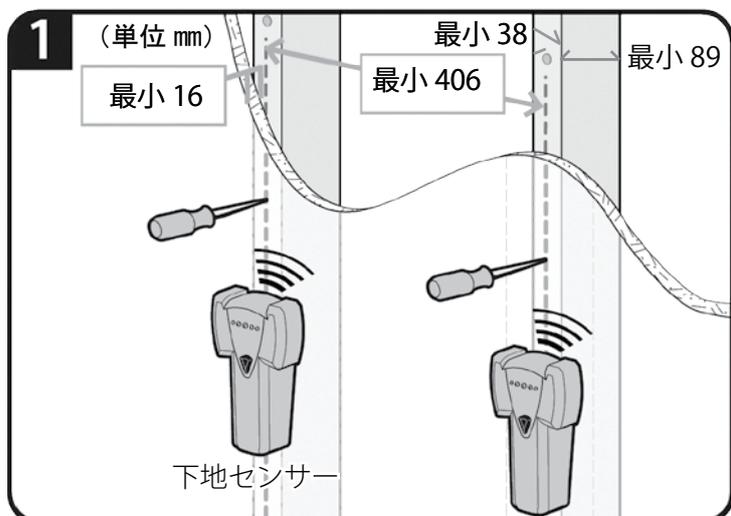
1. 下地センサーや、千枚通しや、細い釘などを使って、下図のように柱の位置を確認します。下地センサーを左右に動かすと、柱の端を検知するので、マーキングします。二つのマーキング（両端）から柱の中心位置にマーキングを付けます。
