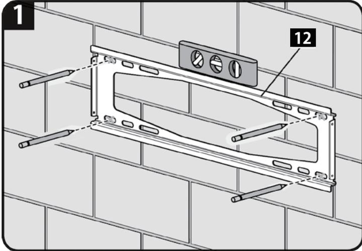
1. 壁掛金具 [12] を、図のようにご希望の高さに置き、市販の水準器で水平度を確認し、4箇所の下穴を開ける位置にマーキングをします。
