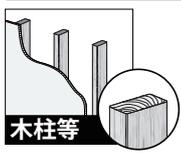
★ 金具を取付ける柱の寸法は、取付ける面の幅 38mm 奥行き 89mm以上が必要です。
