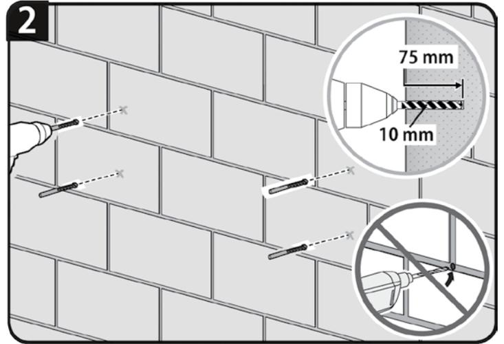
2. マーキングした位置に下穴を開けます。下穴は、10mm 径のドリルビットを使って約 75mm の深さに4箇所開けます。
