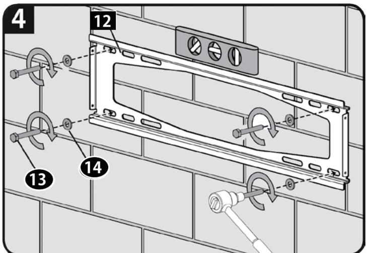
4. 壁掛金具 [12] を下穴に合わせて柱に配置し、水準器で水平を確認しながらラグボルト [13] とラグボルトワッシャー [14] で固定します。
