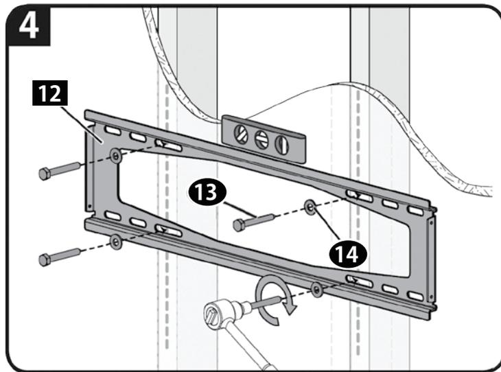
4. 壁掛金具 [12] を下穴に合わせて柱に配置し、水準器で水平を確認しながらラグボルト [13] とラグボルトワッシャー [14] で固定します。
