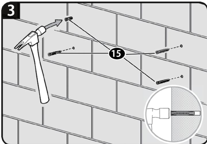
3. 下穴に4個のコンクリートアンカー [15] を挿入します。
