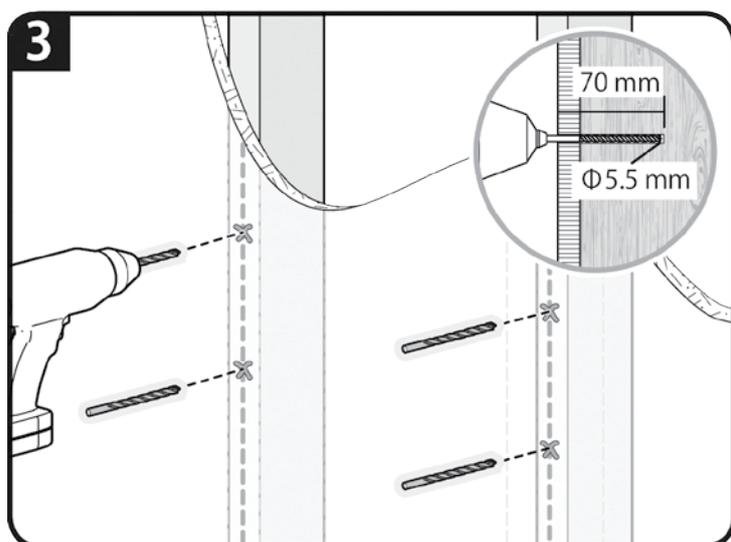
3. 2. で付けたマーキングの位置に下穴をあけます。下穴は、5mm径のドリルビットを使って約70mmの深さに4か所開けます。
