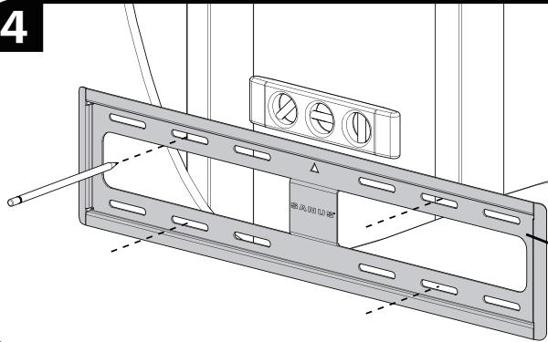
壁掛金具 [03] を、ご希望の高さで仮に配置してください。このとき、取付穴の位置は図のように 2 本の柱の中心線上になるように配置します。図のように、本体の幅の広い方の棧を上にして市販の水準器で水平度を確認しながら、柱に押し付けて仮固定し取付け穴を柱の中心線上の位置に配置した状態で鉛筆でマーキングしてください。
