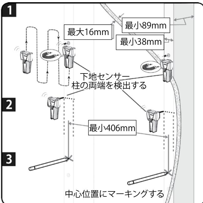
1. 下地センサーや、千枚通しや、細い釘などを使って、右図の様に柱の位置を確認します。
