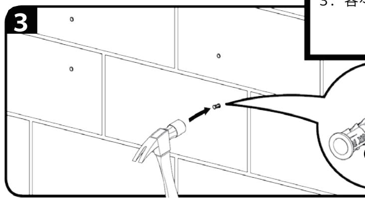
3. 各々 6箇所の穴にコンクリートアンカー [21] を挿入します。
