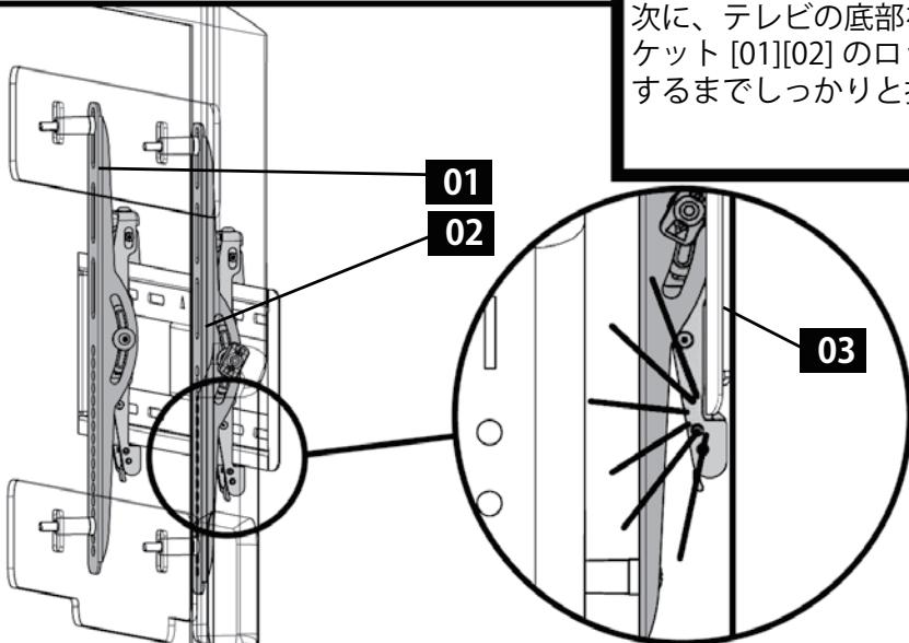
次に、テレビの底部を壁側に押し当てて、TVブラケット[01][02]のロック部分が「カチッ」とロックするまでしっかりと押し当てます。
