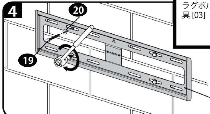
ラグボルト [19] とラグボルトワッシャー [20] を使って、壁掛金具 [03] を壁に取り付けます。
