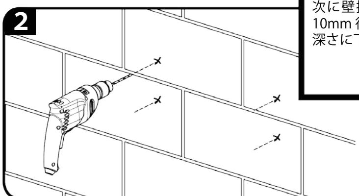
次に壁掛金具 [03] を一旦取除き、マーキングの位置 4箇所に 10mm 径のコンクリート用ドリルビットを使って、約 75mm の深さに下穴を開けます。
