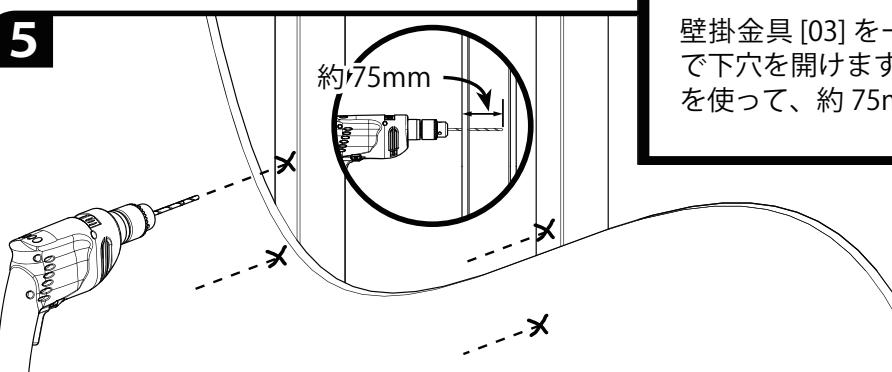
壁掛金具 [03] を一旦取除き、マーキングの位置にドリルで下穴を開けます。柱の下穴は、5mm 径のドリルビットを使って、約 75mm の深さに 4 箇所開けます。
