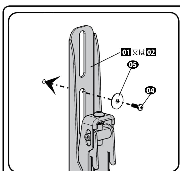
下図のように左右のTVブラケット[01][02]の上下を確認し、それぞれが、テレビの背面上下の中心になるように配置し、1-1、1-2で選択した適合するネジでネジ止めしてください。
