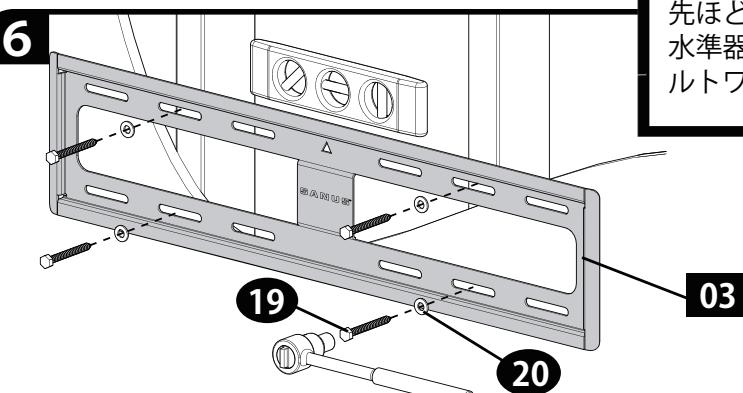
先ほど開けた下穴の位置に壁掛金具 [03] を固定し、市販の水準器で水平度を確認しながら、ラグボルト [19] とラグボルトワッシャー [20] で固定します。
