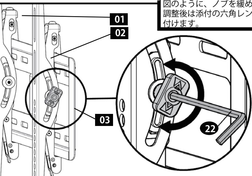
図のように、ノブを緩めてティルト角調整を行い、調整後は添付の六角レンチ[22]でしっかりと締め付けます。
