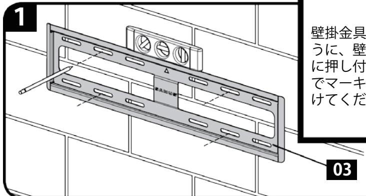
壁掛金具 [03] を、ご希望の高さで仮に配置してください。図のように、壁掛金具 [03] を市販の水準器で水平度を確認しながら、壁に押し付けて仮固定し壁掛金具 [03] の図の穴の位置 4箇所に鉛筆でマーキングしてください。このとき、横の間隔は 20cm 以上空けてください。
