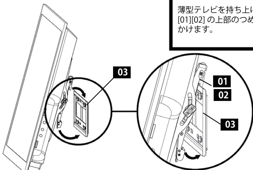
薄型テレビを持ち上げて、左右のTVブラケット[01][02]の上部のつめを、壁掛け金具[03]の上部に引っかけます。
