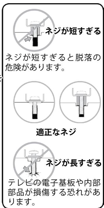
**警告**：ご使用のテレビに対して、ネジやスペーサーを組み合わせて、適正なネジ山のかみ合わせを確認して下さい。首下の短いネジは、テレビを十分保持できず、首下の長すぎるネジは、テレビの内部に損傷を与える恐れがあります。
