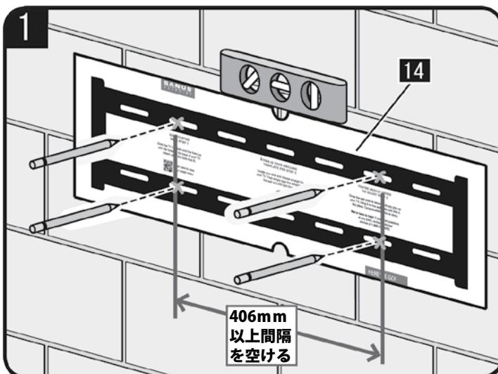
1. 壁面の希望の高さに、壁掛金具型紙[14]を配置します。型紙は水準器で水平を確認してから、穴位置に4箇所のマーキングを付けます。
