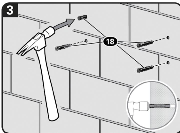
3. 壁掛金具型紙 [14] を取り除いてから、コンクリートアンカー [18] 4 個を壁面に打ち込みます。
