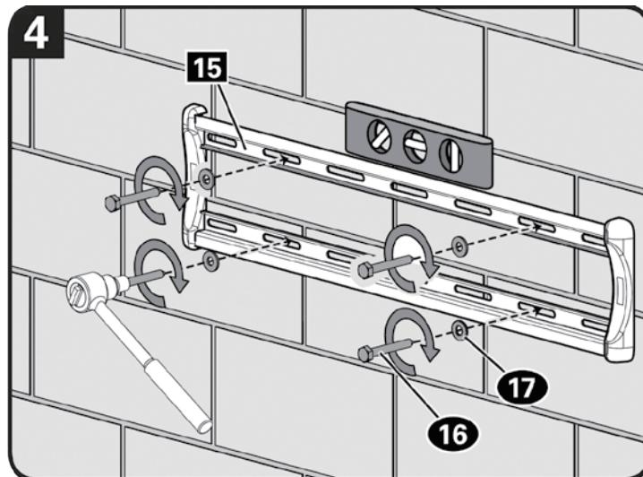
4. 4 本のラグボルト [16] とワッシャー [17] を壁掛金具 [15] にしっかりと締めつけて、壁掛金具 [17] を固定します。
