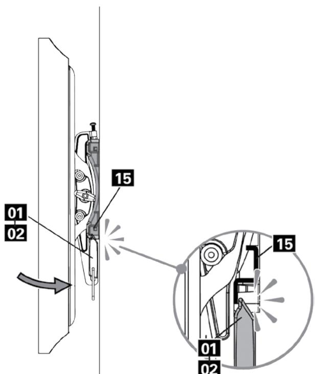
1. STEP 1 でテレビに取付けた TV ブラケット [01] または [02] の上部のスリットを壁掛け金具 [15] の上部に引っ掛けて取り付けます。
