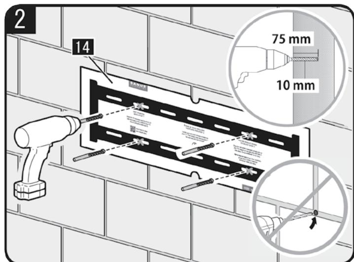
2. 下穴はマーキング位置に 10mm 径のドリルビットを使って、およそ 75mm の深さに穴を 4 個開けます。
