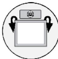
アームアッセンブリー [19] の図の [L] 部の位置にあるネジを 5/32 六角レンチ [26] で緩めると、テレビの水平度が左右 1.5° の範囲で調整できます。
