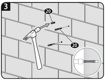
3. 壁掛金具型紙 [16] を取り除いてから、3 個のコンク リートアンカー [20] を壁面に打ち込みます。
