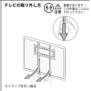
テレビを取り外すには、図のようにストラップを下方向に 引っ張ってロックを外し、テレビを持ち上げて壁掛金具から 取り外します。
