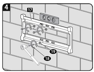
4.3 本のラグボルト [18] とワッシャー [19] を壁掛金具 [17] にしっかりと締めつけて、壁掛金具 [17] を固定します。
