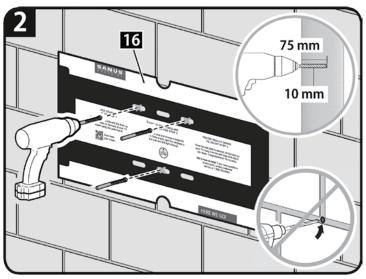
2. 下穴は、10mm 径のドリルビットを使って、必ず75mm の深さに穴を 3 個開けます。
