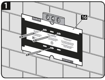
1.壁面の希望の高さに、壁掛金具型紙[16]を配置します。型紙は水準器で水平を確認してから、穴位置に 3 箇所のマーキングを付けます。
