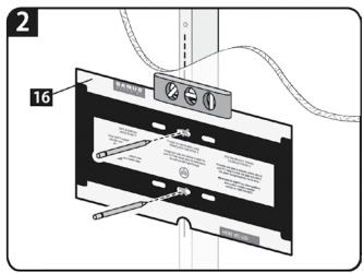
3. 下穴は、柱に 5.5mm 径のドリルを使って、深さ約 75 mm の穴を 2 箇所開けます。
