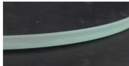
「TGTS01」の断面。厚さ4mmの防弾ガラスをラミネートフィルムで2枚貼り合わせている
