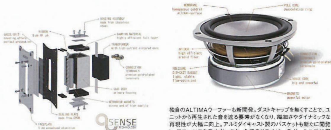
AURUM 9シリーズに搭載されているリボントウイーター。従来のタイプに比べて、垂直方向を短くし、水平方向の幅を広げている。これにより65kHzまでの超低歪で過渡応答特性に優れた高域を実現
