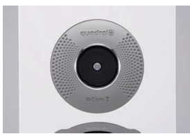
Ricom Σトウイーター部に取り付けられたリングラジエーターは、超軽量(0.31g)のシルク素材で構成されている
